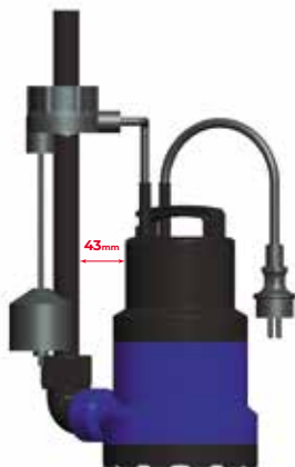
Рис. 3. Минимальное расстояние от корпуса насоса до поплавка.
